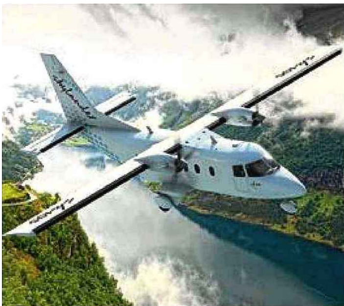
Le prototype Skylander (SK105) est un appareil bipropulseur de 19 places capable de voler à 435 kilomètres par heure.
